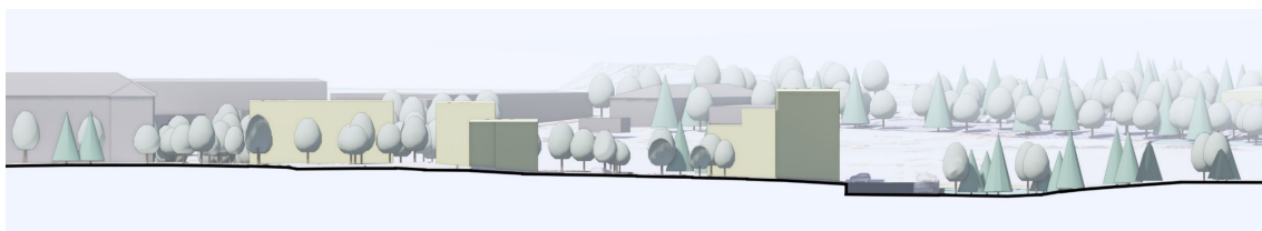
Kuva 49. Suurennotote em. alueleikkauksesta korttelin 33 uudisrakennusten kohdalta. Erik Anttisen tien itäpuolen korkeimmillaan viisikerroksiset uudisrakennukset on porrastettu siten, että kadun puolelta rakennusmassat ovat vain kolmikerroksisia. Pysäköinti tontin itäreunalla sijoittuu notkelmaan ja on siten maastonmuotojen puolesta mahdollista toteuttaa osin kaksitasoratkaisuna. (Kuvälähde: Ramboll, karkean työmallin päivitys ehdotusvaiheen ratkaisun mukaiseksi 2023)
