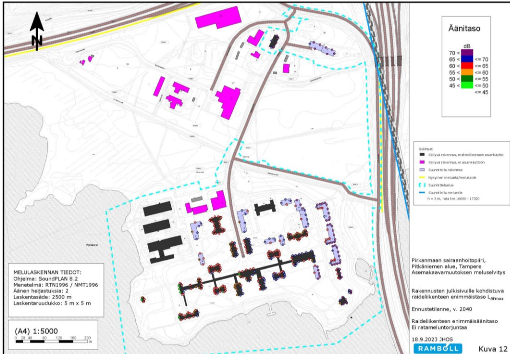
Kuva 26. Havainnekuva melumallinnuksessa radan varteen sijoitettavaksi tutkitun n. 1,3 km pitkän meluaidan sijainnista ja pituudesta. Tutkittua meluaitaa merkkää kuvassa sininen ohut viiva tulevan radan länsipuolella. Meluaita ei sijoitu kaava-alueelle eikä sen toteutuksesta päätetä mitään tähän kaavaprosessiin liittyen, vaan vasta radan mahdollisen tarkemman suunnittelun ja toteutuksen yhteydessä. (Lähde: Ramboll, 2023)
