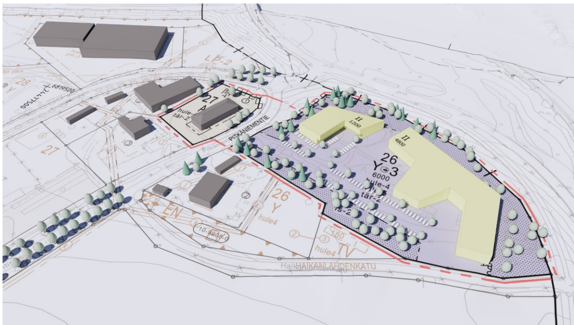
Kuva 43. Ote maankäyttösuunnitelman työmallista pohjoisosan kaava-alueiden kohdalta. Ratkaisu on tältä osin esitetty samana kummassakin vaihtoehtoluonnoksessa. Rakennusmassoista on pyritty muodostamaan hyvin muurimaisia tiealueiden melun suuntaan. Alueen porttina pääsaapumissuunnassa sijaitsevaan kortteliin on mahdollista sijoittaa esimerkiksi kaupungin julkisia toimintoja, hallinnollisia tiloja ja päivittäistavarakauppa. Korttelialueen eteläreunalla pyritään säilyttämään olemassa olevaa puustoa. (Lähde: Ramboll, 2021)
