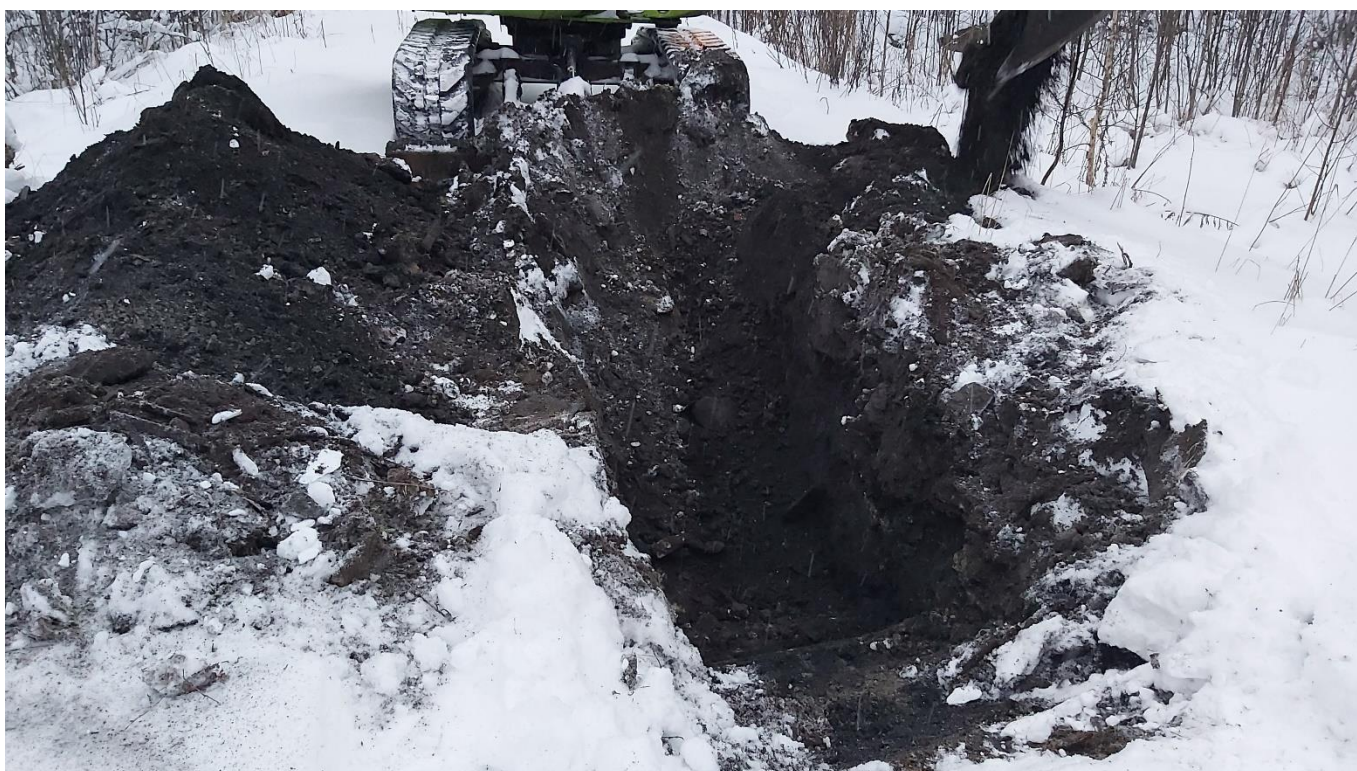
Kuva 2. Koekuopat ulotettiin tuhkerrokseen asti. Tuhkerros sijaitse vaihtelevasti 0,1 – 1,5 metrin syvyydessä ja oli 10 – 100 cm vahvuinen, riippuen tutkimuspisteestä.
