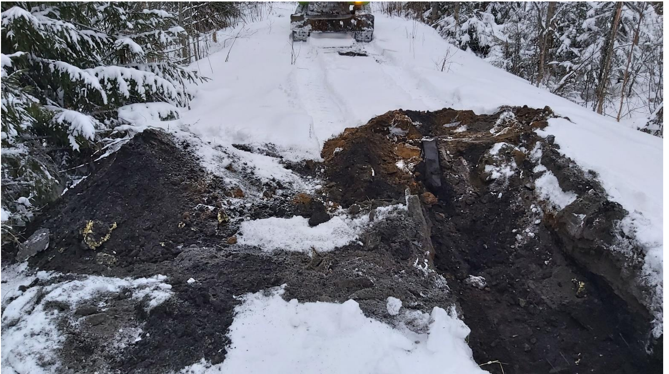
Kuva 7. Yhdessä tutkimuspisteessä havaittiin pieniä määriä lasivillaa tuhkan seassa. Muissa pisteissä ei havaittu jätettä.
