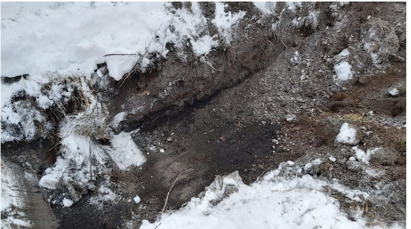
Kuva 6. Pintamaan täyttömaata tummempana erottuva tuhkakerros koekuopan pohjalla.
