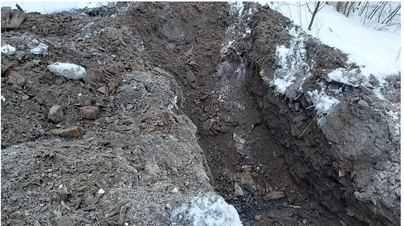
Kuva 3. Osassa koekuoppia oli havaittavissa sekalaista täyttömaata sekä mm. tiilen- ja puunkappaleita tuhkerok- sen yläpuolella.
