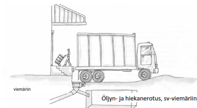
Kuva 3.4. Esimerkiksi kemikaalien lastausalueen kattamisesta ja suoja-altaasta (vaarallisten kemikaalien ja öljyjen vastaanottopisteet), vedet voidaan johtaa tarvittaessa viemäriin.
