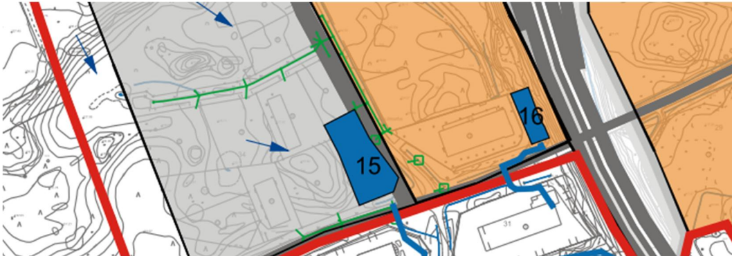
Kuva 5.17. Porintien eteläpuolen hulevesien hallintarakenteet. Rakenne 15 on toteutettu, rakenne 16 on suunniteltu.
