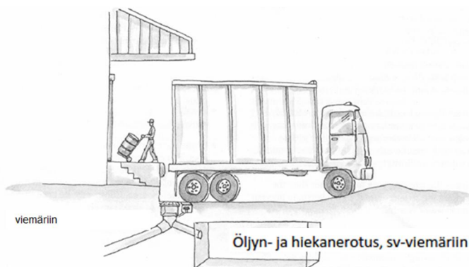
Kuva 3.4. Esimerkiksi kemikaalien lastausalueen kattamisesta ja suoja-altaasta (vaarallisten kemikaalien ja öljyjen vastaanottopisteet), vedet voidaan johtaa tarvittaessa viemäriin.
